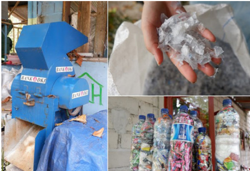
Gambar IV.3 Mesin Pencacah Sampah (kiri), sampah plastik yang dicacah (kanan atas) dan eco-brick dalam Program Pulauku NOL Sampah
